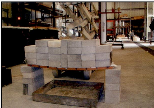
ZDJĘCIE 4 – drugi poziom odporności ogniowej, obciążenie 400kg
