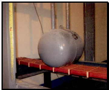
ZDJĘCIE 4 – krata pomostowa z żywicy fenolowej, wykonana w technologii odlewania w całości
