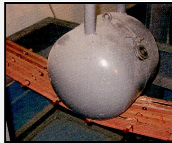
ZDJĘCIE 5 – krata fenolowa wykonana w technologii pultruzji
