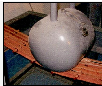
ZDJĘCIE 5 – krata fenolowa wykonana w technologii pultruzji
