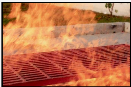
ZDJĘCIE 1 – krata fenolowa podczas 20 min. ekspozycji w otwartym ogniu
