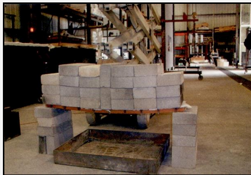
ZDJĘCIE 4 – drugi poziom odporności ogniowej, obciążenie 400kg
