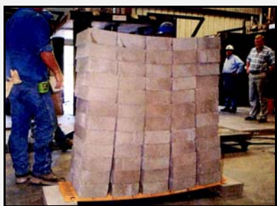
ZDJĘCIE 6 – drugi poziom odporności ogniowej, kraty fenolowe PHI
