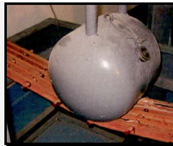
ZDJĘCIE 5 – krata fenolowa wykonana w technologii pultruzji
