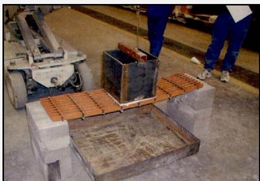
ZDJĘCIE 3 – trzeci poziom odporności ogniowej, obciążenie 40kg w temp. 100°C
