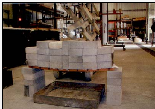
ZDJĘCIE 4 – drugi poziom odporności ogniowej, obciążenie 400kg
